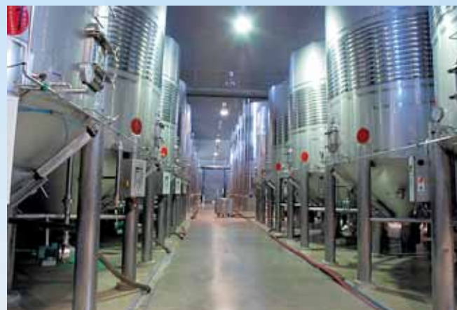
FABRIKK: Vinen gjærer på enorme tanker i fabrikkhallen, og prosessen overvåkes nøye ved hjelp av moderne teknikk.
